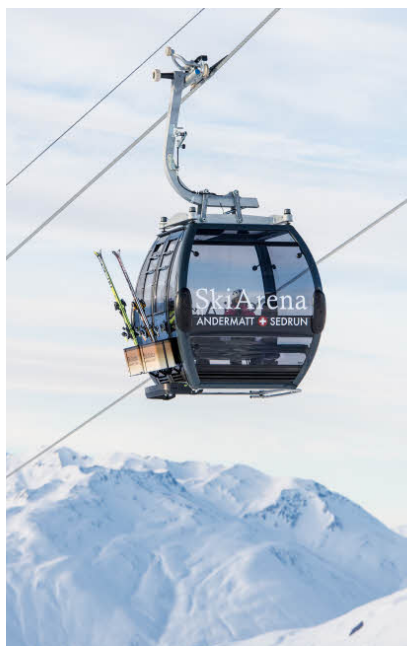
Die neue Gondelbahn von Leitner hat eine Förderleistung von 2400 Personen pro Stunde.
